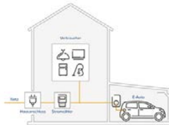
Bild 16 - Ladestation hinter dem Hausstromzähler (Quelle: eniviaM)
