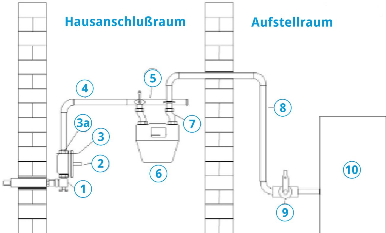
1. **Hauseinführungskombination** Mit Hauptabsperreinrichtung (HAE) und Isolierstück
