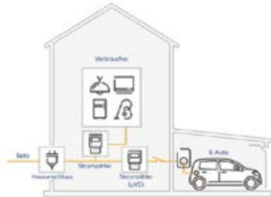
Bild 15 - Ladestation mit gesondertem Stromzähler (Quelle: eniviaM)
